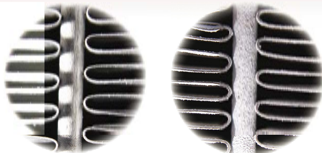
TSD BN サーマルコーティング施工後 フィンの表面がボロンの結晶で プロテクトされています
